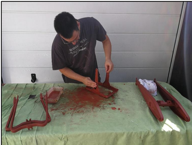
Ci-dessus le sablage de la partie cycle avant d'appliquer le primaire rouge, puis microbillage de la visserie.
