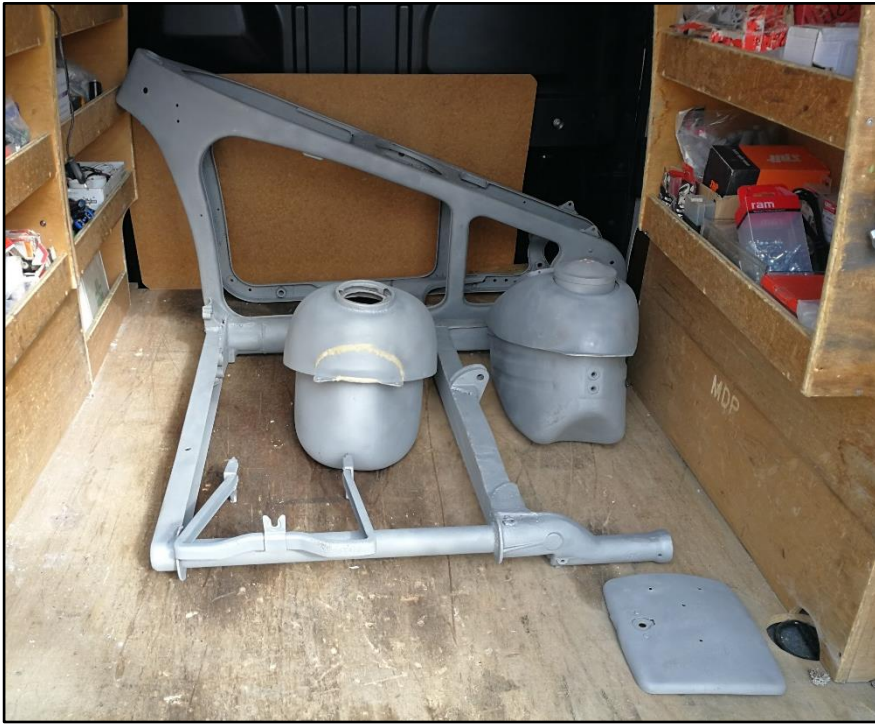
Ci-dessus le sablage de la partie cycle avant d'appliquer le primaire rouge, puis microbillage de la visserie.
