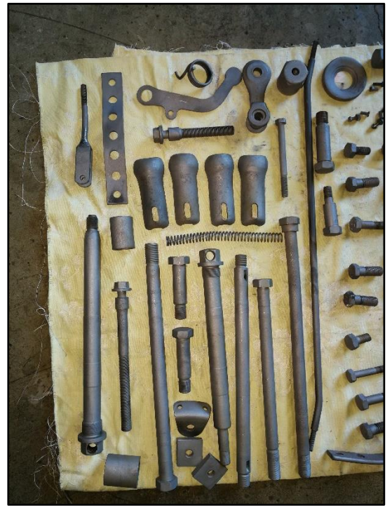
Ci-dessus le sablage de la partie cycle avant d'appliquer le primaire rouge, puis microbillage de la visserie.
